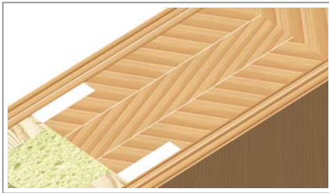
Detail - ALLWETTER Türblatt-Rohling (gegen Aufpreis)
