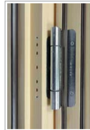
17 3 x BÄNDER Belastungswert 160 kg, Rollendurchmesser 20 mm, Oberfläche Topzink
