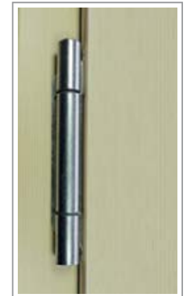
17 3 x BÄNDER Belastungswert 160 kg, Rollendurchmesser 20 mm, Oberfläche Topzink
