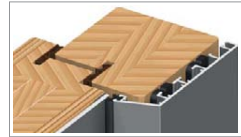
Detail - Alu-Schale Außen & drei Dichtungsebenen
