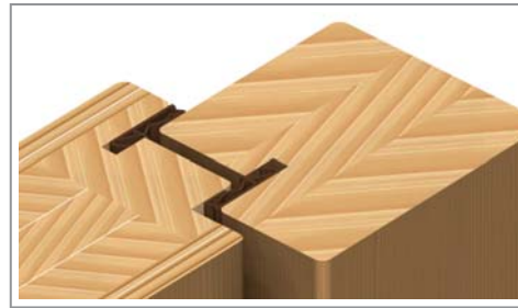
Detail - zwei Dichtungsebenen
